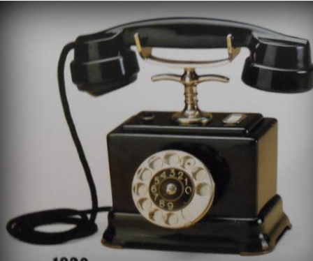
1930. Automatapparat med fingerskiva. Käpa i plåt och mikrotelefon, eller "bur" som den kom att kallas, i bakelit.
