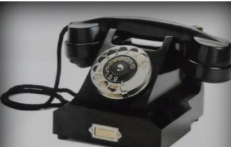
1933. Fjärta banttelefonen som tillverkades helt i bakelit. Samtidigt ersattes metallhykan för telefonluren av två tryckknappar.
